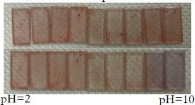
pH-senzorski filmovi na pločicama od PETG-a
