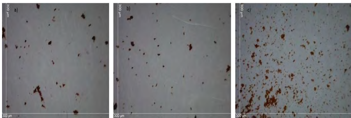
Slika 1 – Mikroskopski prikaz čestica pripremljenih mješavina kave s dodatkom sladne kavovine u određenim postocima: (a) čista (mljevena) kava (U0 %), (b) mješavina kave s 50 %-tnim udjelom sladne kavovine (U50 %) i (c) sladna kavovina (U100 %)
