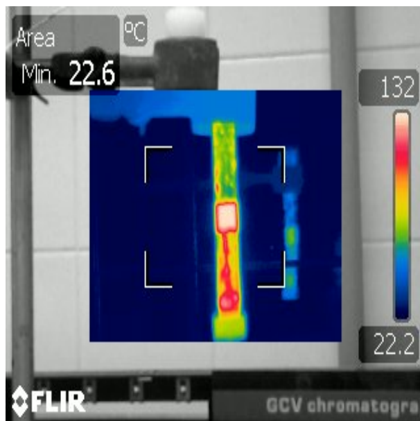
Slika 7. Termografski snimak reakcije očvršćivanja pri maksimalnoj temperaturi u središtu kalupa
