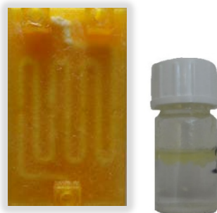
Slika 6. Milireaktor izrađen od PETG-a nakon provedene sinteze i skupljeni produkt u vijali Figure 6. Millireactor made of PETG after synthesis and product collected in a vial
