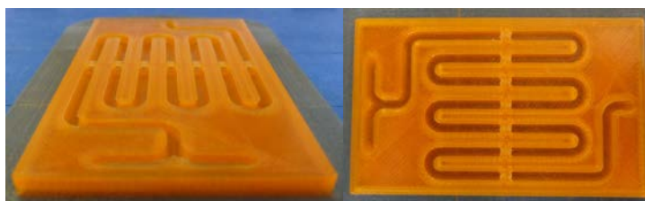
Slika 3. Fotografija milireaktora sa sedam pregrada tijekom izrade FFF-om Figure 3. Photography of a millireactor with seven baffles during FFF fabrication
