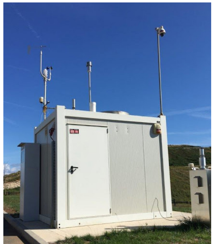
Slika 8 – S ciljem praćenja stanja okoliša, unutar ŽCGO Kaštijun postavljena je automatska mjerna postaja za praćenje kvalitete zraka. Praćenje kvalitete zraka i prijenos izmjenjenih podataka na mrežne stranice nadležnog Ministarstva povjereno je ovlaštenom laboratoriju sukladno važećim propisima.
