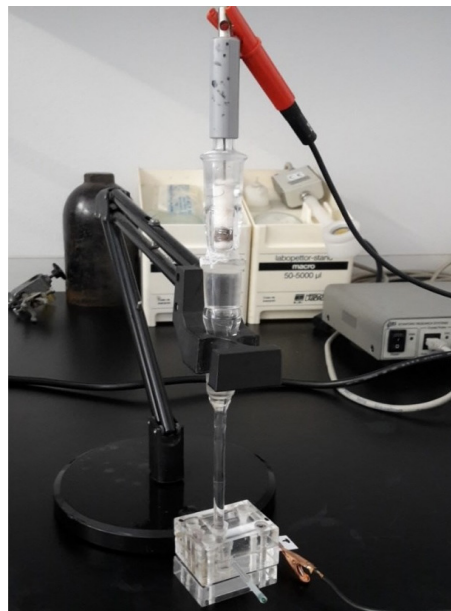
Slika 3 – Neprotočna ćelija za potencijometrijsko mjerenje
