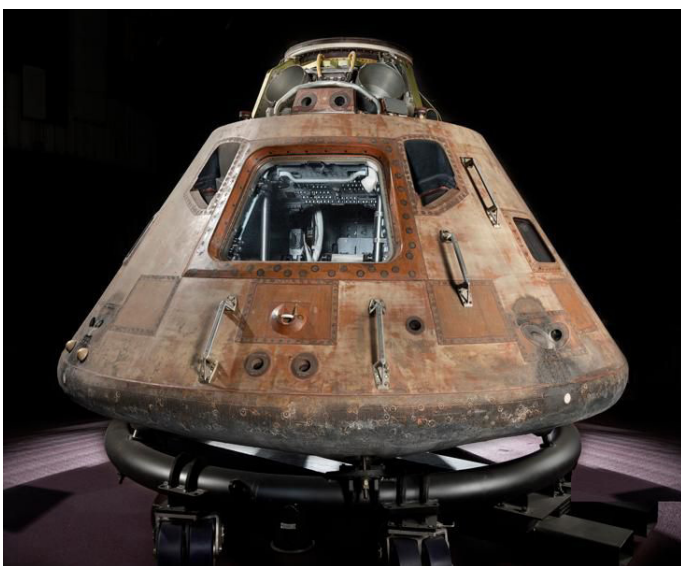
Slika 1 – Aluminijska ljuštura upravljačke kabine Apolla 11
