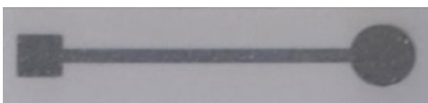
Slika 2 – Printana, all-solid plošna srebrova elektroda
