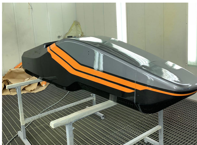
Slika 2 – Kompozitna monocoque šasija bolida Vulpes
