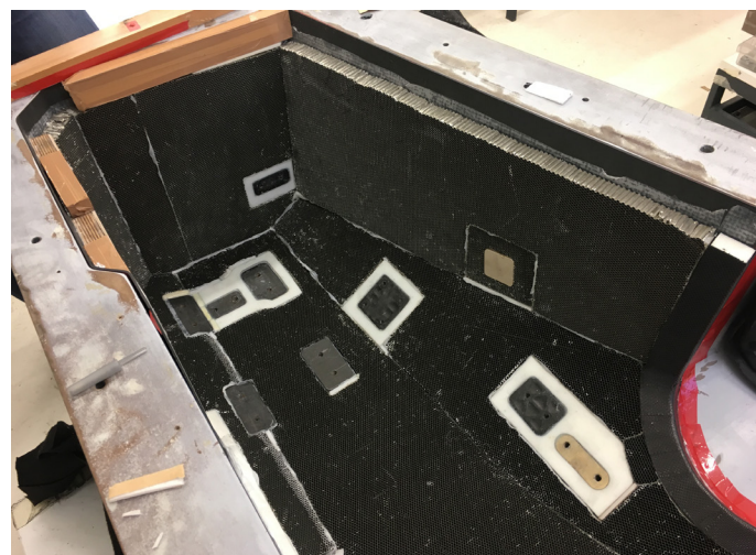
Slika 3 – Sendvič struktura šasije s aluminijskim saćem
