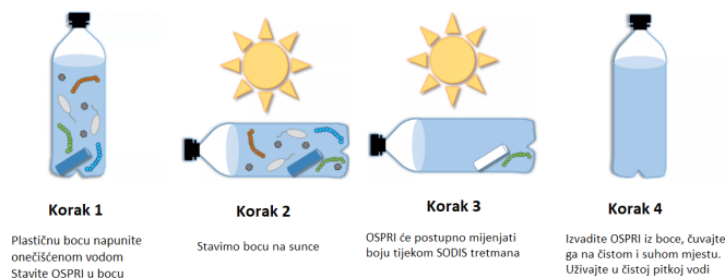
Slika 4 – Pročišćavanje vode SODIS metodom u PET bocama 4
