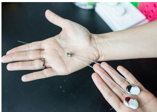
Slika 1 - Mini-jurati sustav za doziranje vrlo malih količina lijeka
