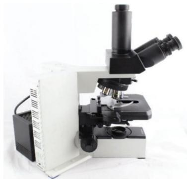
**Opis metode:** Optička (svjetlosna) mikroskopija uključuje prolaz vidljive svjetlosti kroz promatrani objekt, te zatim kroz jednu leću ili sustav leća. Moguć je i rad sa svjetlošću reflektiranom od objekta. Slika se detektira okom, fotografskom pločom ili digitalnom kamerom.
