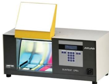
**Opis metode:** SUNTEST CPS+ uređaj koristi se za izlaganje i ispitivanje starenja uzoraka izloženih svjetlosnom zračenju.
