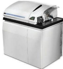
**Opis metode:** Tekući uzorak ionizira se uvođenjem u plazmu argona, nakon čega se provodi mjerenje koncentracije spektrometrom masa.
