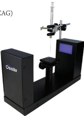
**Opis metode:** Postav mjeri kontaktni kut kapljice na površini. Ovo je korisno mjerjenje močenja površine i površinske energije.
