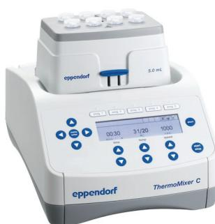
**Opis:** Tresilice s grijanjem i hlađenjem su instrumenti dizajnirani za održavanje konstantne temperature i miješanje epruveta i mikropločica na unaprijed određenoj temperaturi i brzini miješanja. Mehanizam orbitalnih mućkalica uključuje motor pričvršćen na platformu koja drži posude dok se uređaj trese za miješanje, miješanje ili miješanje tvari u posudama.
