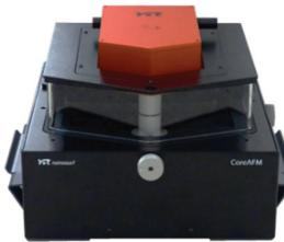
**Opis metode:** Mikroskopija atomskih sila omogućuje vizualizaciju primarno mikrostrukture uzoraka tankih filmova i prašaka, a posljedično omogućuje dobivanja informacija o mehaničkim modulima, hrapavosti površine i sl. Dodatnim probama i softverskim modulima omogućeno je proučavanje elektromagnetske prirode materijala i analiza uzorka velikog raspona hrapavosti, veličine čestica, tvrdoće i ostalih svojstava.
