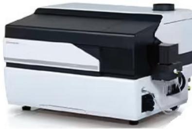
**Opis metode:** ICP-MS je tehnika elementarne analize. Koristi argon (Ar) plazmu (ICP) za pretvaranje uzorka u ione koji se zatim izravno mjere masenim spektrometrom (MS). Ova tehnika omogućuje brzu analizu više elemenata u uzorku i najbolji je izbor za analizu elemenata u tragovima. Uredaj je pogodan za kvantitativnu i kvalitativnu kemijsku analizu. Što se tiče kvantitativnog određivanja, radi u rasponu do 9 redova veličina.
