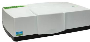
**Opis metode:** UV-Vis-NIR spektrofotometar omogućuje analizu optičkih svojstava tekućih uzoraka ili tankih filmova. Moguća je kvantitativna i kvalitativna analiza optičke transmisije i apsorpcije. Integrirajuća sfera kao nadogradnja omogućuje analizu uzoraka u čvrstom stanju, kao i optičke refleksije uzoraka. Također omogućuje i određivanje difuzne refleksije uzoraka uz pomoć dodatnih nastavaka pomoću čega se naknadno određuje energijski procijep poluvodičkih materijala.
