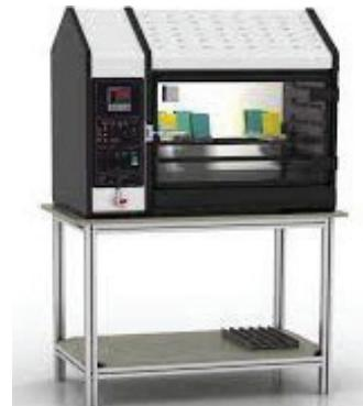
**Opis metode:** Ispitivanje korozjske otpornosti obavlja se na različitim materijalima s ili bez premaza smještanjem uzorka u termostatiranu komoru uz zasićenje atmosfere vodenom parom i kondenzaciju ili uz naizmjениčne cikluse suhovlažno. Materijal izložen takvoj atmosferi može korodirati u ovisnosti o sastavu, površinskim svojstvima i svojstvima premaza.
