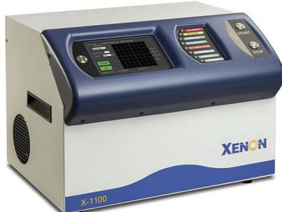
**Opis metode:** Intenzivna pulsirajuća svjetlost je kratkotrajni bljesak (do 100 µs) ksenonske lampe koje emitira uglavnom vidljivu svjetlost (190 nm do 1100 nm) uzrokovano stvaranjem električnog luka između volframovih elektroda pod visokim naponom (1000 V – 3000 V). U usporedbi s drugim metodama obrade materijala, intenzivna pulsirajuća svjetlost je energetski i vremenski učinkovita i zadovoljava zahtjeve održivog razvoja.
