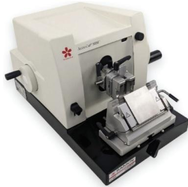
**Opis metode:** Rotacijski mikrotom Accu-Cut® SRM™ 200 je ručno upravljeni uređaj za precizno rezanje uzoraka i dobivanje vrlo tankih presjeka, uglavnom mekih materijala i biološkog tkiva za mikroskopska ispitivanja.
