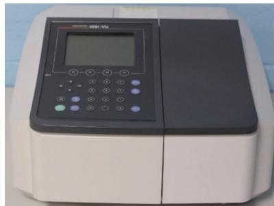
**Opis metode:** Spektrofotometrija je način određivanja koncentracije tvari u uzorku mjerjenjem količine svjetla koju je uzorak apsorbirao.
