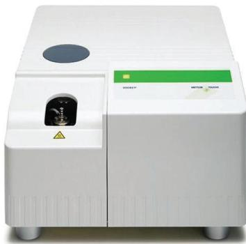
**Opis metode:** Mettler Toledo DSC823e je uređaj za diferencijalnu pretražnu kalorimetriju zasnovan na Boersminom načelu (načelu toplinskog toka). U osnovnoj primjeni, ispitivani i referentni uzorak zagrijavaju se po unaprijed zadanim programu, a mjeri se razlika temperatura dvaju uzoraka tijekom zagrijavanja, koja je posljedica razlika u njihovim toplinskim svojstvima.
