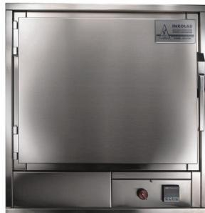
**Opis metode:** Termostati se koriste u laboratorijskim ili ispitnim odjelima kako bi omogućili termostatiranje ili inkubiranje uzoraka. Postoje 2 izvedbe uređaja, s opcijom prisilne cirkulacije zraka i s opcijom prirodnog strujanja zraka. Linija BT s prisilnom cirkulacijom zraka pospješuje temperaturnu homogenost radnog prostora zbog jednolike cirkulacije zraka.
