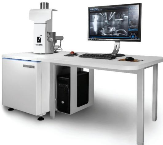
**Opis metode:** Pretražna elektronska mikroskopija (SEM) je metoda kojom se dobiva slika uzorka (povećana do 100 000 puta) prelaskom fokusiranog snopa elektrona po površini vodljivog uzorka. Kontrast slike ovisi prvenstveno o topografiji uzorka, a ovisno o detektoru (detektor povratno raspršenih elektrona, BSE) i o atomskom broju atoma u uzorku. Instrument je opremljen i detektorom za energijski razlučujuću rendgensku spektroskopiju (EDS) koji omogućuje elementnu analizu uzorka.
