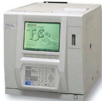
**Opis metode:** Metoda mjerjenja zasniva se na kombiniranoj oksidaciji uzorka vode pomoću persulfata, UV zračenja i zagrijavanja na 80 °C. Ugljik u vodenim uzorcima prevodi se u CO<sub>2</sub> koji se detektira pomoću neraspšrujućeg IR (NDIR).
