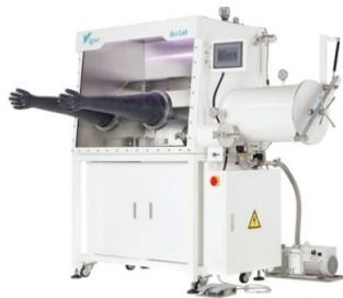
**Opis metode:** Uredaj za rad u zaštitnoj atmosferi s dvije prekomore omogućuje uspješnu sintezu i obradu uzoraka nestabilnih i/ili reaktivnih pri atmosferskim uvjetima.
