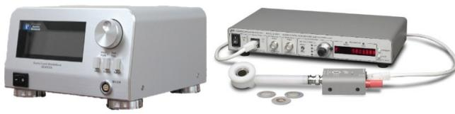
**Opis metode:** Kvarc kristalna mikrovaga/nanovaga mjeri masu i viskoznost u procesima koji se odvijaju na ili blizu površina, ili unutar tankih filmova. Kvarcni kristali se mogu prethodno prevući tankim filmom bilo kojeg materijala, uključujući metale, organske polimere, hidrogelove, kompozite, keramiku, biomolekule, bakterije i žive stanice.
