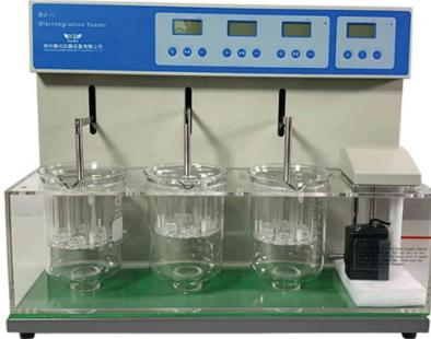
**Opis metode:** Metoda za određivanje raspadljivosti tableta definirana je Europskom farmakopejom (Ph. Eur. 2.9.1., metoda A). Mjerenjem se dobiva informacija raspadaju li se one u potpunosti u propisanom vremenu i uvjetima u tekućem mediju.
