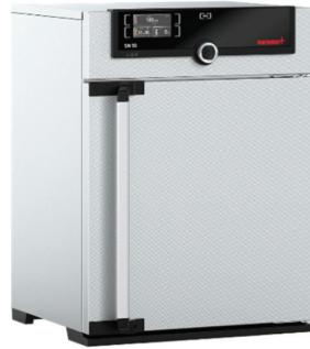
**Tehnički opis uređaja:** Unutarnje dimenzije uređaja su 400 x 400 x 330 mm, volumena 53 L. Točnost 0,1-0,5 °C. Temperaturni senzor Pt100 DIN A klase. Ugrađen digitalni ekran za upravljanje uređajem. Plinovi nastali unutar uređaja se mogu ispuštiti u laboratorij u definiranoj količini pomoću ugrađenog ventila (0-100 % u koracima od 10 %). Maksimalna masa uzorka je 80 kg.
