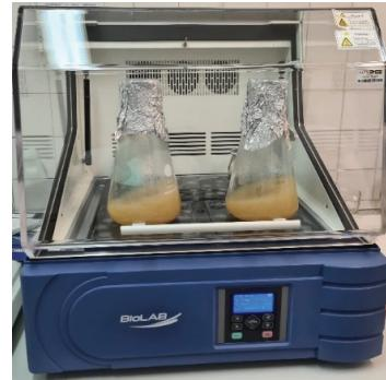
**Opis:** Tresilice s grijanjem i hlađenjem su instrumenti dizajnirani za održavanje konstantne temperature i miješanje epruveta i mikropločica na unaprijed određenoj temperaturi i brzini miješanja. Mehanizam orbitalnih mućkalica uključuje motor pričvršćen na platformu koja drži posude dok se uređaj trese za miješanje, miješanje ili miješanje tvari u posudama.
