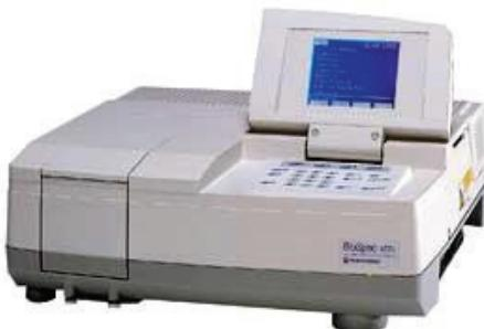
**Opis metode:** Spektrofotometrija je način određivanja koncentracije tvari u uzorku mjerjenjem količine svjetla koju je uzorak apsorbirao.
