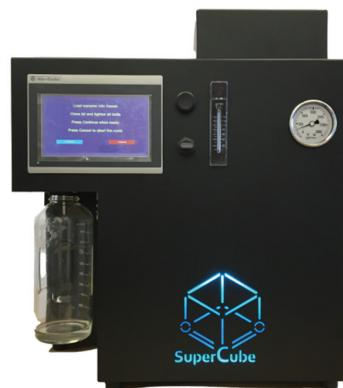
**Opis metode:** Sušenje uzorka superkritičnim fluidom omogućuje kontrolu poroznosti i raspodjelu veličina pora unutar uzorka bez stvaranja kapilarnih sila prilikom sušenja. Impregnacija superkritičnim fluidom omogućava homogenu raspodjelu željenog materijala unutar pora visokoporoznih sustava.
