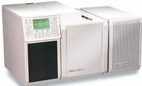
**Opis metode:** GC radi na principu da će se smjesa pri zagrijavanju razdvojiti na pojedinačne tvari. Zagrijani plinovi prolaze kroz kolonu s inertnim plinom (kao što je helij). Kako odvojene tvari izlaze iz otvora kolone, dolaze u MS u kojem se detektiraju mase pojedinih komponenti uzorka. Osim toga, CP-3800 se jednostavno konfigurira za izvođenje on-line analiza za praćenje kritičnih procesnih tokova plina i tekućina.
