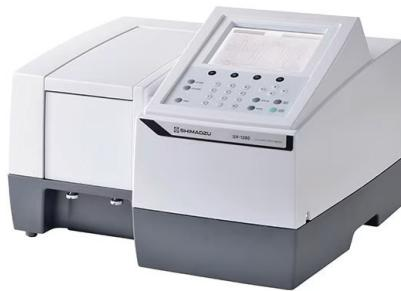
**Opis metode:** UV-Vis spektroskopija je analitička metoda za mjerenje valne duljine u ultraljubičastom i vidljivom dijelu elektromagnetskog spektra koja se apsorbira ili prolazi kroz uzorak. Prolaskom svjetlosti kroz uzorak dolazi do pobudivanja elektrona na višu energetsku razinu zbog apsorpcije energije. Na valnu duljinu utječe sastav uzorka te se koristi za identifikaciju komponenata prisutnih u uzorku i mjerjenje koncentracije.
