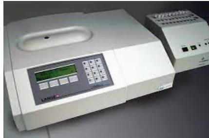
**Opis metode:** Određivanje ekotoksičnosti vodenih uzorka korištenjem bakterije *Vibrio fischeri* provodi se na luminometru prema standardiziranoj metodi ISO 11348:2007. Kivete moraju biti u termostatiranom bloku na 15 °C 15 minuta prije početka izvođenja testa. Potrebno je napraviti resuspenziju bakterije. Luminiscencija 0,5 ml suspenzije mora biti najmanje 1000.
