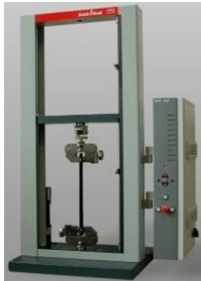
**Opis metode:** Univerzalna mehanička kidalica služi mehaničkom ispitivanju rastezne čvrstoće, cijepanja, odvajanja, smika, relaksacije i histerezze. Uredajem se upravlja preko računala koje je opremljeno odgovarajućim programima. Kidalica služi određivanju mehaničkih karakteristika uzorka, u područjima istraživanja i razvoja, kontrole kvalitete i kontrole proizvoda.
