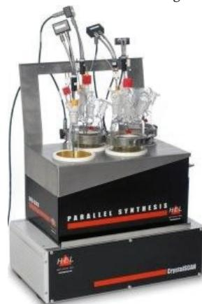
**Opis metode:** Provodenje procesa kristalizacije u 4 odvojena kristalizatora čiji se procesni uvjeti mogu pojedinačno podešavati. Uz automatizirano miješanje, zagrijavanje i hlađenje kristalizatora, moguće je automatski dodavati otapalo/antisolvent u održenoj brzinom. Podaci o topljivosti i točki nukleacije mogu se automatski odrediti za različite procesne uvjete što omogućava optimizaciju procesa kristalizacije te prikupljanje podataka potrebnih za uvećanje procesa.
