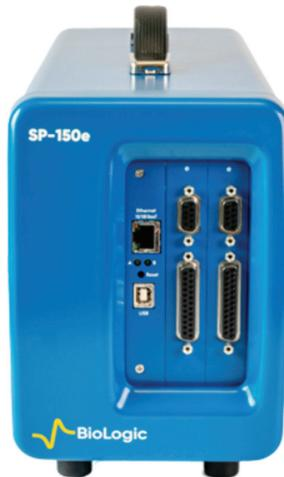
**Opis metode:** Potencijostat omogućava da se između radne i referentne elektrode narine određeni potencijal i da struja teče između radne i protu elektrode. Rad je moguć u troelektrodnom ili dvoelektrodnom sustavu. Pomoću softverskog alata EC-Lab potencijostat može koristiti više od 80 različitih metoda; potencioamperometrijskih, pulsnih i impedancijskih tehnika.
