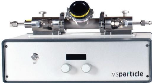
**Opis metode:** Ablacija iskrom omogućava sintezu nanočestica metala i metalnih oksida uz pomoć plazme koja se stvara pri iskrenju u inertnom ili reaktivnom plinu. Pomoću ove tehnike moguće je sintetizirati prahove te tanke filmove na raznim supstratima.
