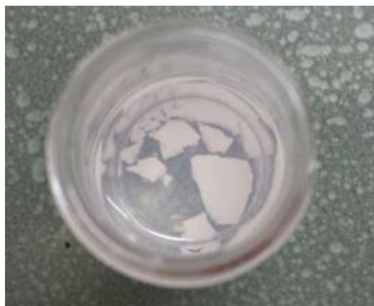
Slika 15. Ponašanje materijala Z-PCABS u acetonu
