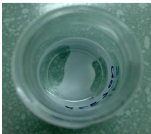
Slika 17. Ponašanje materijala Z-HIPS u acetonu
