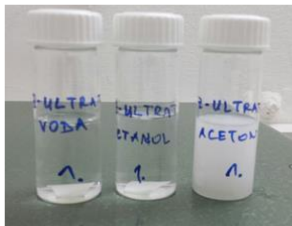
Slika 13. Ponašanje materijala Z-ULTRAT u sva tri otapala
