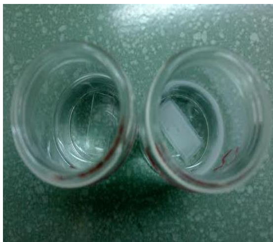
Slika 21. Ponašanje materijala Z-GLASS u vodi (lijevo) i acetonu (desno)
