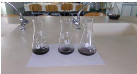
Slika 12. Prikaz završene titracije standardne otopine vitamina C Fig. 12. The endpoint of titration of standard vitamin C solution
