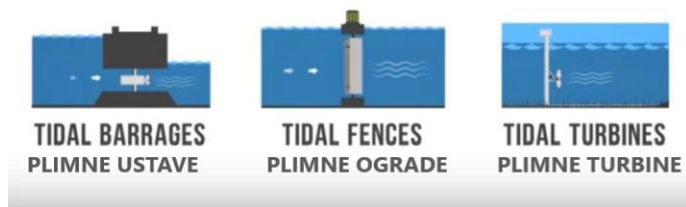
Slika 2 – Tri tipa elektrana pogonjenih morskim mijenama
