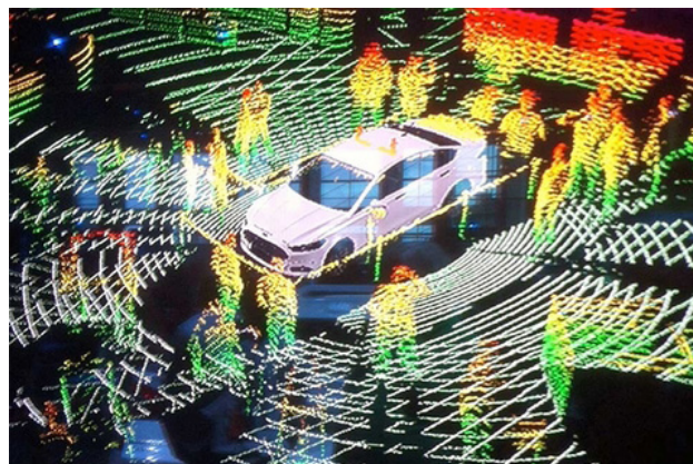
Slika 1 – Snimanje okoline u stvarnom vremenu LIDAR senzorom
