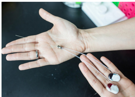
Slika 1 - Minijaturni sustav za doziranje vrlo malih količina lijeka
