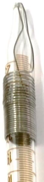
Slika 7. Žica namotana na graduiranoj pipeti (cijev)
