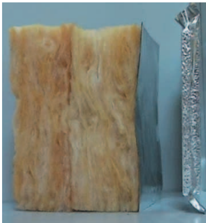
■ Detalj "klasične izolacije" u usporedbi s VIP izolacijom koja je za postizanje iste toplinske provodljivosti i do desetak puta tanja
