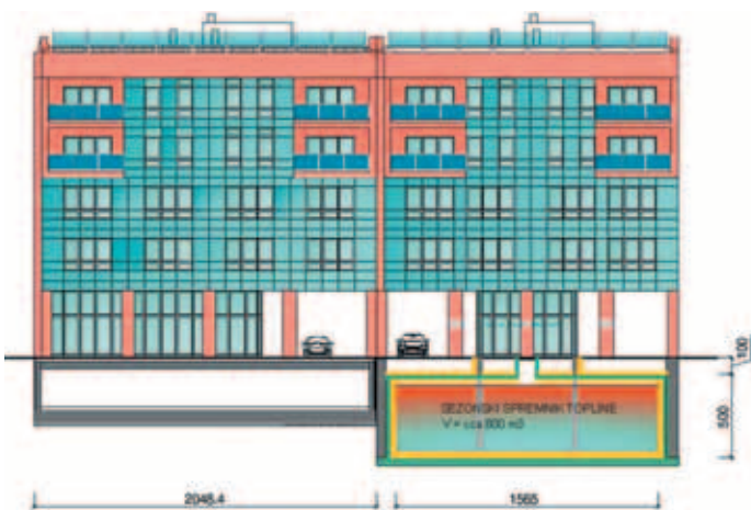
■ Izgled južnih fasada zgrade Agria po novom projektu Fakulteta kemijskog inženjerstva i tehnologije na kojima se vide solarni zidovi (svjetlo plave boje), vakuumski solarni kolektori (tamno plave boje na ogradama balkona i svjetlo plave boje na krovu zgrade) i sezonski spremnik topline
