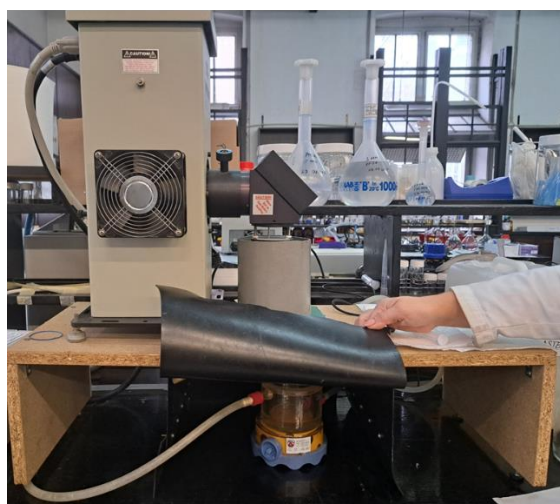
Slika 2. Aparatura za fotokatalitičku razgradnju modelne otopine pod solarnim zračenjem.
