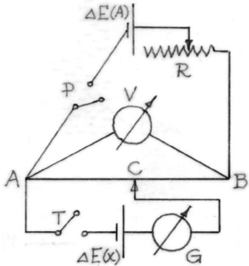
Kad se napon na položaju AC izjednači s EMS galvanskog članka, galvanski članak zbog načina spajanja izvora struje (pozitivno na pozitivno, negativno na negativno) zaustavlja protok struje i kazaljka na galvanometru (G) se ne pomiče.
