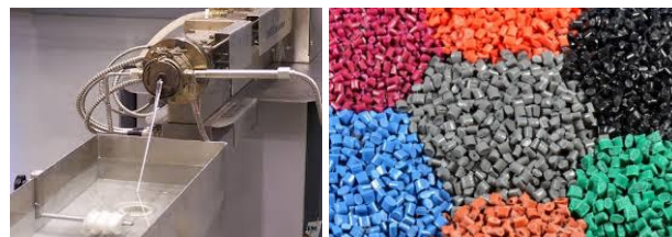
Granuliranje polimerni filament se hladi vodom ili zrakom i reže u granule
