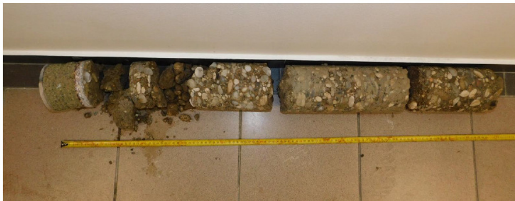
Slika 5 Uzorak iz temelja na poziciji 2
