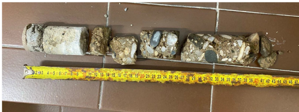
Slika 2 Uzorak iz temelja na poziciji 1
