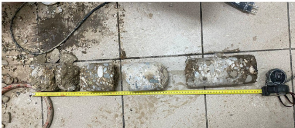
Slika 8 Izbušeni uzorak temelja
