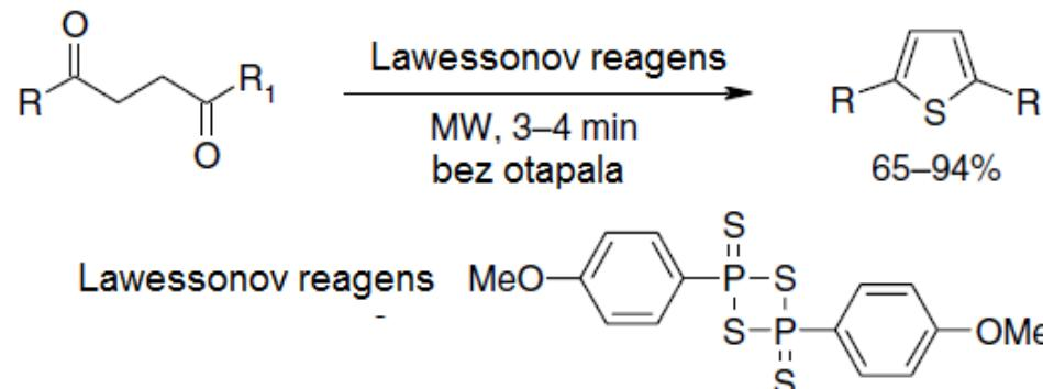
*MW potpomognute sinteze derivata tiofena*
