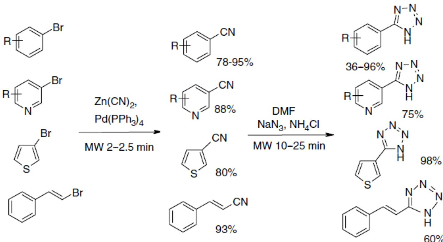
***MW potpomognute sinteze derivata tetrazola***
