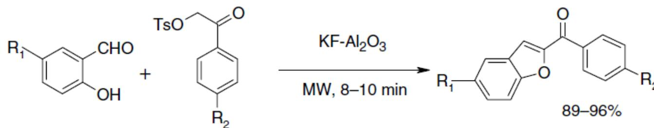
*MW potpomognuta sinteza benzofuranskih derivata*
