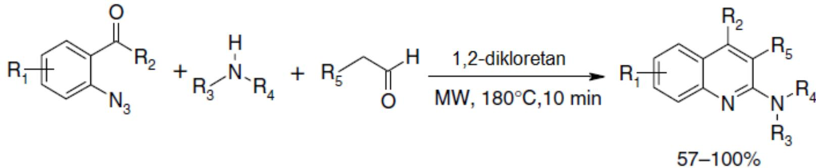
*MW potpomognuta sinteza derivata 2-aminokinolina*
