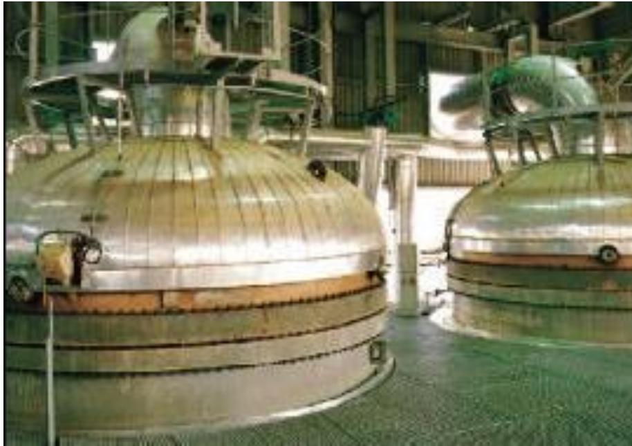
Industrijski reaktori za oksidaciju \text{NH}_3
