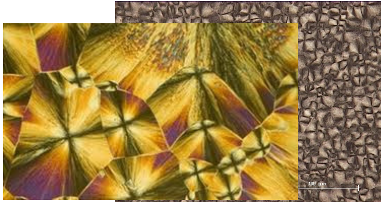
sferulitna struktura – povezani radijalni sferuliti
