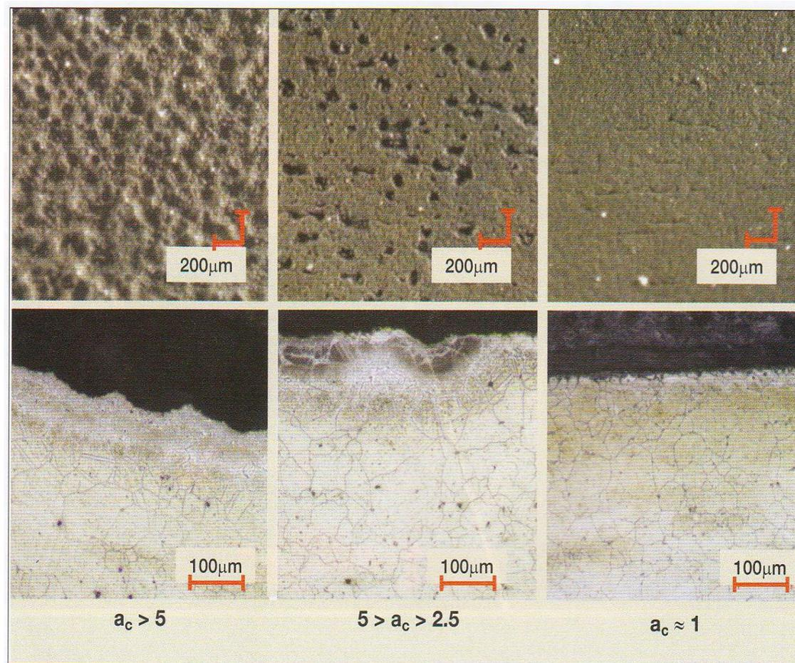
Prikaz morfologije unutarnje površine (gornje slike) i presjeci nakon jetkanja (donje slike) cijevi izrađenih od slabo otporne slitine nakon 8000 sati rada u uvjetima sklonim MD koroziji kao funkcija aktiviteta ugljika,  $a_c$ .
