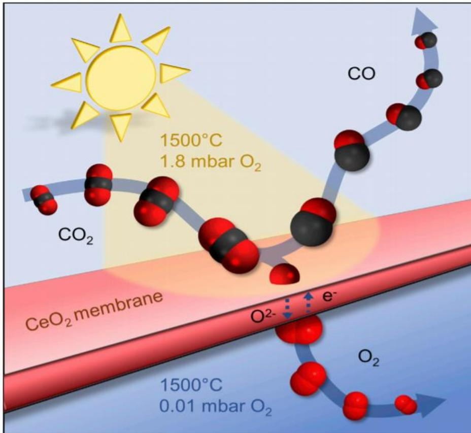
Konverzija CO<sub>2</sub> u gorivo putem termokemijskog procesa na sunčevo zračenje - solarni reaktor kontinuirano cijepa CO<sub>2</sub> preko redoks membrane u odvojene tokove CO i O<sub>2</sub> pomoću koncentriranog sunčevog zračenja (solarni toranj).
