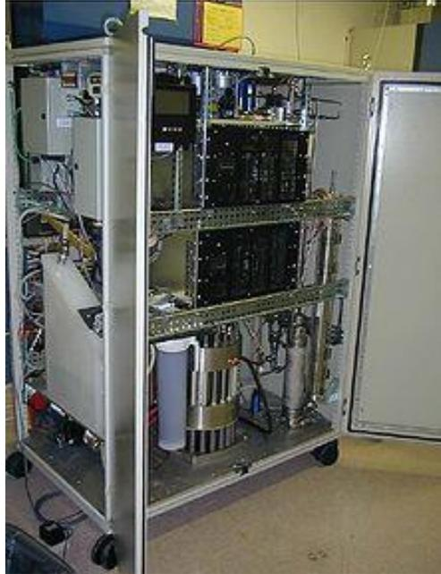
Visokotlačni PEM elektrolizer
