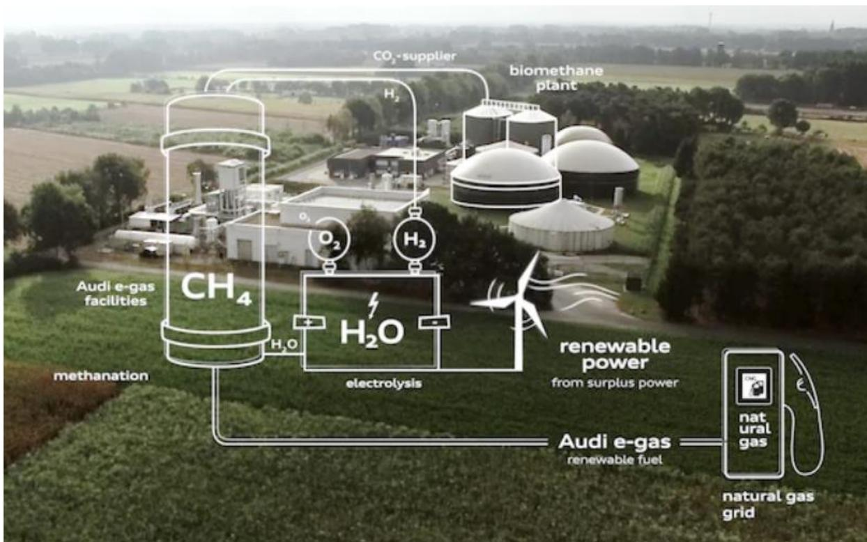
Tehnološka shema procesa proizvodnje sintetskog metana od CO<sub>2</sub> i zelenog vodika dobivenog elektrolizom vode
