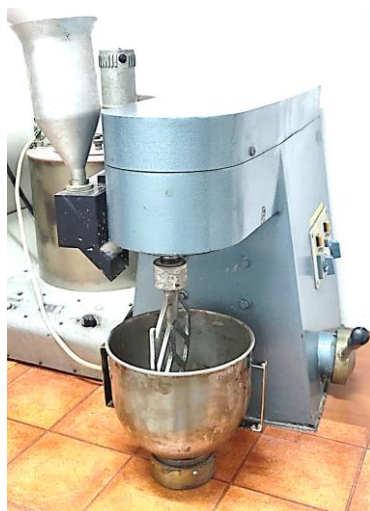
Slika 7. Mikser za pripremu morta zapremnine 5 L.
