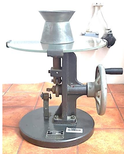
Slika 6. Potresni stol za ispitivanje konzistencije.
