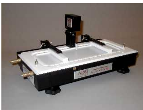
Sl. 18. Langmuirova vaga za mjerenje površinski filmova
