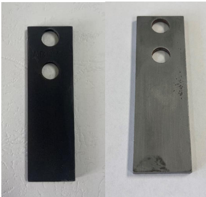
Slika 16. Izgled (a) neočišćene i (b) očišćene površina ugljičnog čelika AISI 1018 nakon 3 dana izlaganja sintetskoj slojnoj vodi zasićenoj s \text{CO}_2 u prisutnosti 10 \text{ mg dm}^{-3} \text{CeCl}_3 , pri atmosferskom tlaku i temperaturi od 60^\circ\text{C}
