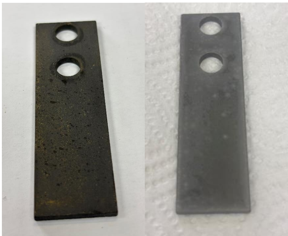
Slika 38. Izgled (a) neočišćene i (b) očišćene površina ugljičnog čelika AISI 1018 nakon 3 dana izlaganja sintetskoj slojnoj vodi zasićenoj s \text{CO}_2 u prisutnosti 10 \text{ mg dm}^{-3} \text{CeCl}_3 , pri atmosferskom tlaku i temperaturi od 80^\circ\text{C}
