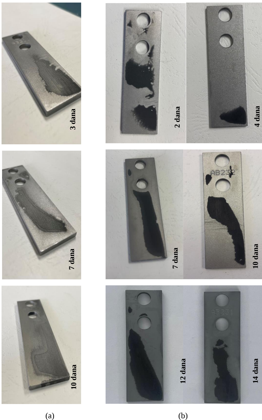
Slika 57. Izgled površina ugljičnog čelika AISI 1018 nakon određenih vremena izlaganja sintetskoj slojnoj vodi zasićenoj s \text{CO}_2 u prisutnosti (a) 10 \text{ mg dm}^{-3} IOA i (b) smjese 5 \text{ mg dm}^{-3} \text{CeCl}_3 i 5 \text{ mg dm}^{-3} IOA, pri atm. tlaku i temperaturi od 40^\circ \text{C}
