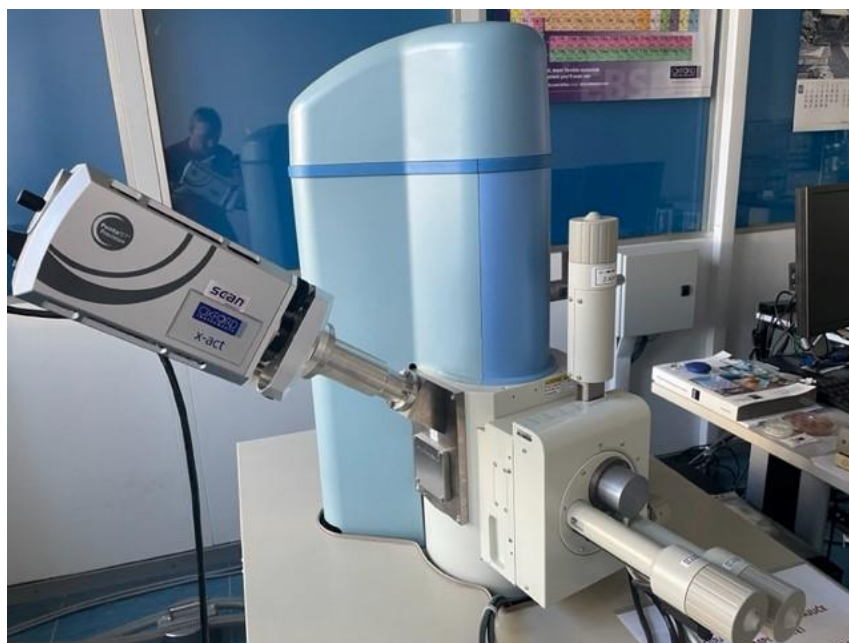
Slika 11. Optički mikroskop i povezani pretražni elektronski mikroskop s modulom za energijski razlučujućom rendgenskom spektroskopijom
