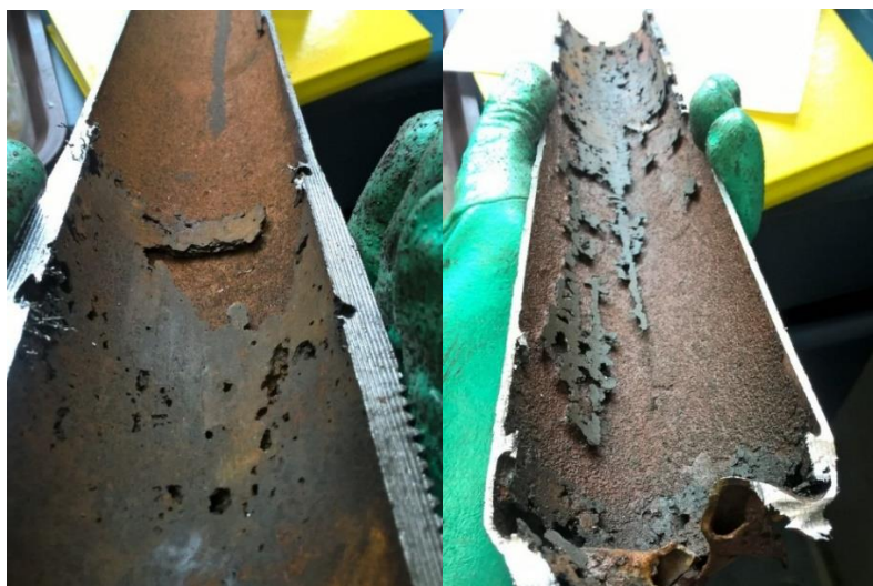
Slika 5. Proizvodna cijev ( engl. tubing ) iz naftne bušotine polja Ivanić oštećena djelovanjem tipične „mesa“ korozije
