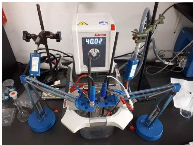
Slika 3.10 Ispitivanje u masi otopine elektrode s pločicom 1,9 x 1,9 cm pri povišenoj temperaturi
