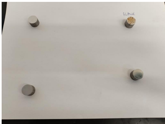
Slika 4.3 Izgled kupona čelika nakon djelovanja inhibitora A u kiseloj kiši
