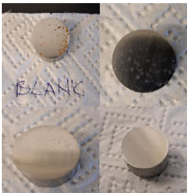
Slika 4.4 Izgled kupona čelika nakon djelovanja inhibitora A u 1% NaCl
