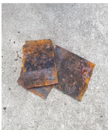
Slika 3.8 Pločice korodiralog metala uzete s terena
