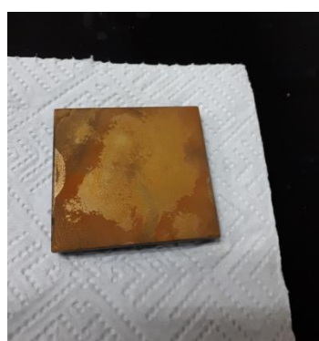
Slika 3.7 Laboratorijski dobivena hrđa na uzorcima metala
