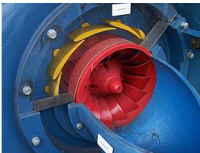
Slika 8. Presjek Francis turbine (izvor: Wikipedia)
