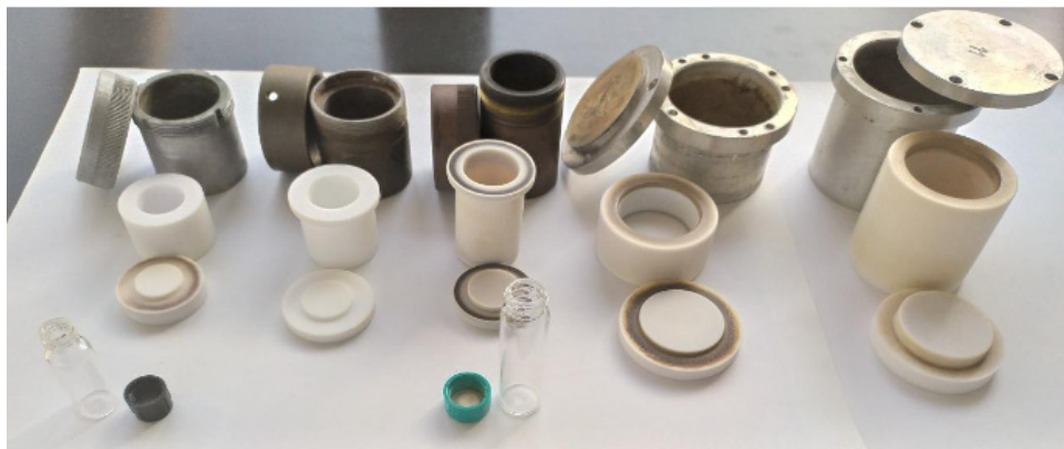
Teflonski autoklavi raznih veličina i staklene posudice s navojnim čepovima
