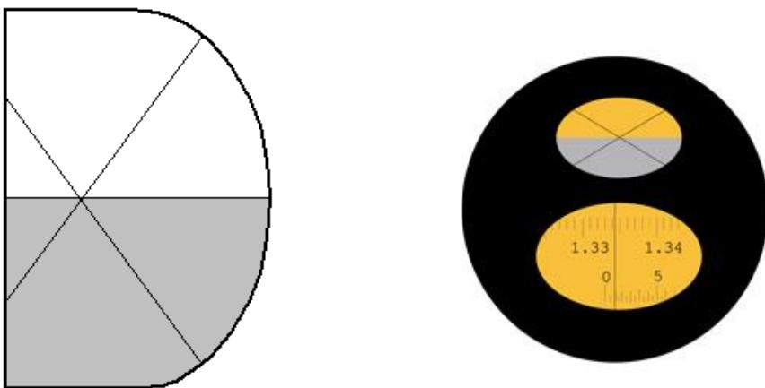
Isti se postupak mjerena ponovi s uzorkom kapljevite faze. Rade se po tri mjerena uzorka za obje faze te se uzima njihova srednja vrijednost. Iz izmjerene vrijednosti indeksa loma, na temelju funkcijeske ovisnosti  $w(\text{cikloheksan}) = f(n_{D,25})$  (baždarna krivulja) izračunava se maseni udio obje komponente u fazi tj. određuje se sastav faze.
