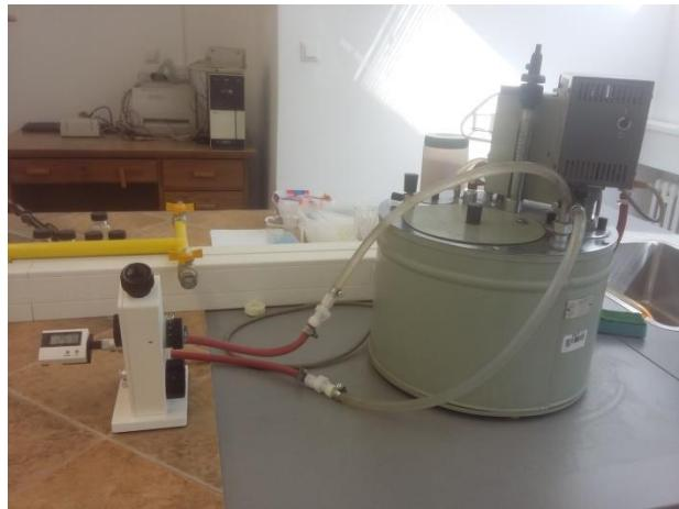
Prizma refraktometra dobro se očisti vatom s acetonom (p.a.). Zatim se pomoću staklene šprice s metalnom iglom jednolikou nanese sloj uzorka kondenzata parne faze na površinu prizme i brzo zatvori poklopcem prizme jer se želi spriječiti isparavanje hlapljivog organskog uzorka i promjena njegova sastava.
