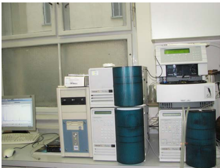
Tekućinski kromatograf s detektorom s nizom dioda i fluorescentnim detektorom
