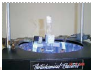
Fotokemijski reaktor RPR 100 Photochemical reactor RPR 100
