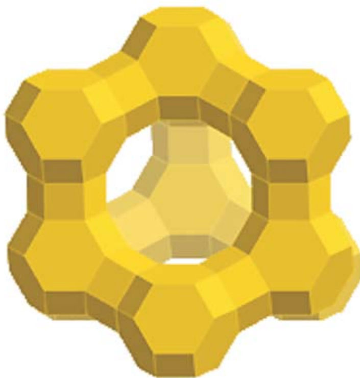
Struktura klinoptilolita. Clinoptilolite structure.
