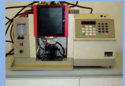
Atomski apsorpcijski i emisijski spektrometar
